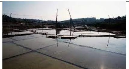
A água dele extraída é sete vezes mais salgada que a do mar. O processo é rudimentar e semelhante ao usado nas salinas da beira-mar, da exposição ao sol e ao vento e consequente evaporação da água obtém-se o sal, depositado no fundo dos talhos, o qual depois é colocado em montes, em forma de pirâmides, para secar até ser recolhido.
